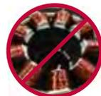
Расплавление изоляции обмоток компрессора
