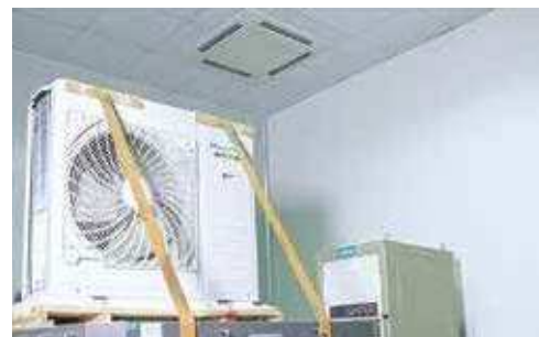
Вибростенд имитации транспортировки
