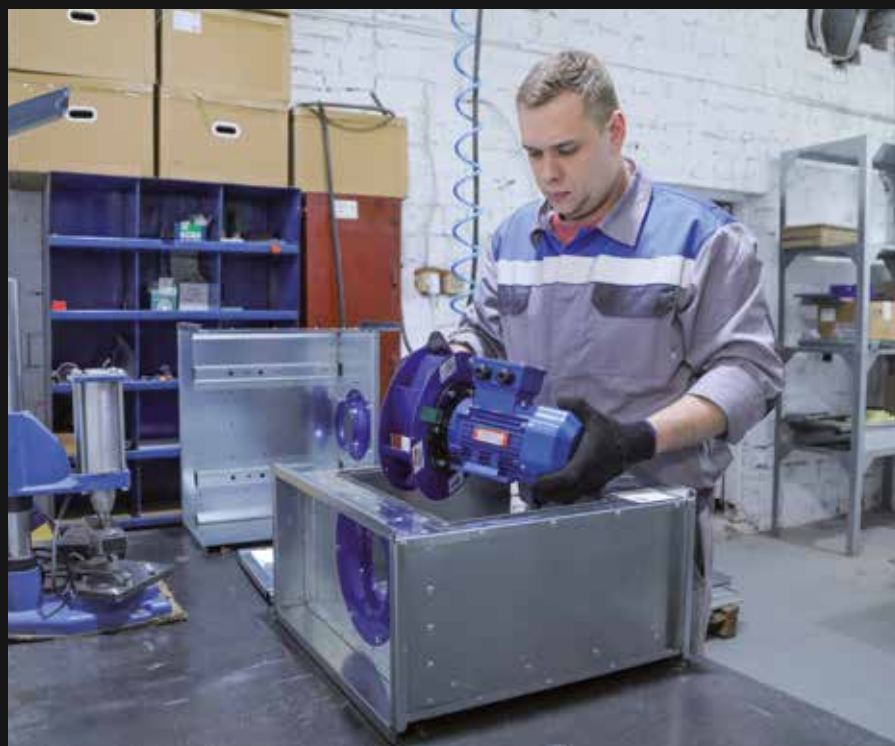
Производство элементов сборной вентиляции
