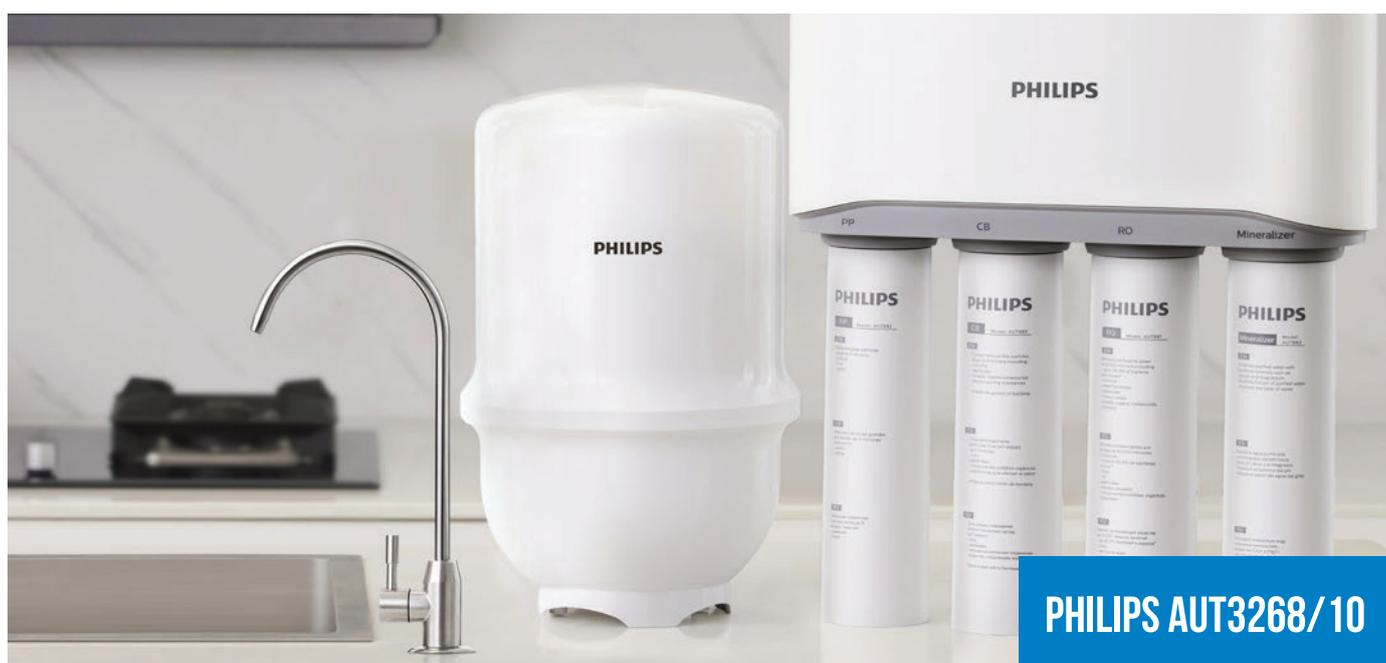
AUT3268/10 это классическая система обратного осмоса с накопительным баком. Система имеет два этапа предварительной очистки, блок с обратноосмотической мембраной и **минерализатор, который восполняет баланс кальция и магния в воде, а также улучшает ее вкус.**
